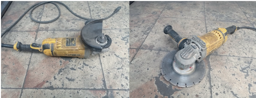
Figura 1. (Izquierda) Una amoladora con tapa de protección; (Derecha) una amoladora sin tapa de protección
